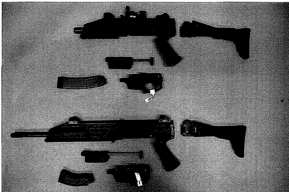
Abbildung 5: Vergleichsansicht linke Seite, oben die vollautomatische „CZ Scorpion EVO 3 A1“, unten die halbautomatische CZ Scorpion EVO 3 S1 Carbine 16“, beide zerlegt in die jeweiligen Hauptgruppen
